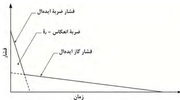
شکل ۲۱-۳-۱۵- فشار دوخطی ناشی از انفجار داخلی
