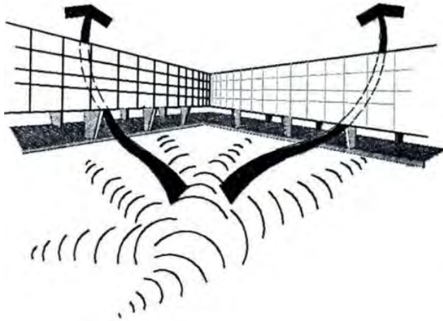
شکل ۲-۲۱-۵- تخلیه موج انفجار از پیلوت باز
