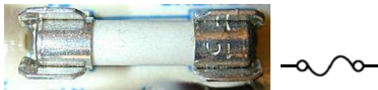
یک فیوز در محل مربوطه از درون منبع تغذیه یک کامپیوتر
