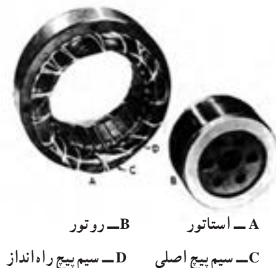
شکل ۹-۷- روتور و استاتور موتور مشعل
